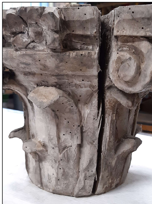
Ill. 45 : Détail d'un chapiteau. Une large fente de dessiccation traverse l'élément sculpté, source d'accumulation de poussière et partant d'humidité, facteur propice au développement des insectes xylophages.
