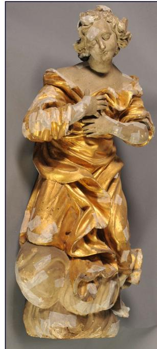
La principale altération consiste en d'importants soulèvements de matière, conséquence d'une conservation dans un milieu déficient sur le plan climatique ; le bois s'étant rétracté.
